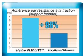
"+" : il offre une **adhérence remarquable** directement sur support maçonnerie. C'est un système monoproduit, impression et finition.
